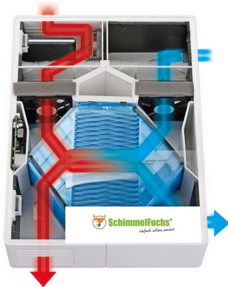
Durch zwei getrennte Lüfter werden Zu- und Abluft dem Wärmetauscher im Kreuz-Gegenstromverfahren zugeführt. Dieses Verfahren ermöglicht eine Wärmerückgewinnung von bis zu 90% im Winter bzw. eine Vorkühlung der Außenluft im Sommer. Des Weiteren stellt dieses System einen großen Vorteil gegenüber sog. „Pendellüftern“ dar. Im Gegensatz zu Geräten mit einfacher Kera-
